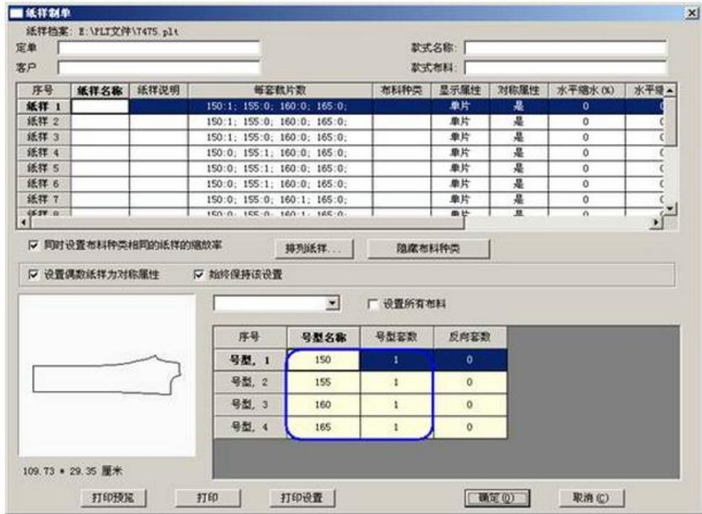
在【纸样制单】对话框中输入所排唛架的比例，单击确定，导入的 PLT 文件就会在唛架上从左至右按照由小到大显示各号型纸样，如下图所示。
